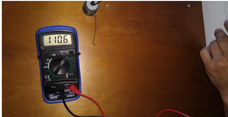
Figura 10: Tensão na saída do inversor do protótipo
